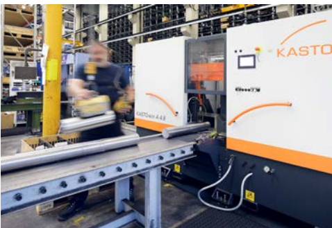
Sägezuschnitte auf CNC-gesteuerten Sägeanlagen
